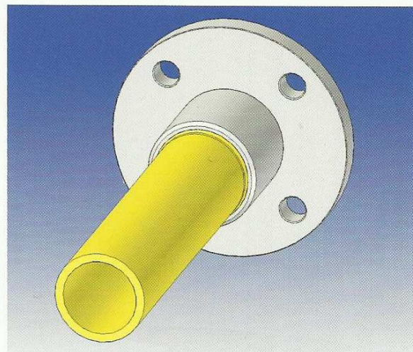
Na szkicu przedstawiono połączenie PE-STAL DN50
